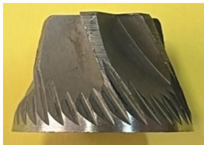
Рисунок 2- Вальцы измельчителя зерна: валец подвижный (а); валец неподвижный (б); вальцы измельчителя, в зазоре между которыми находится зерно при его дезинтеграции (в)
